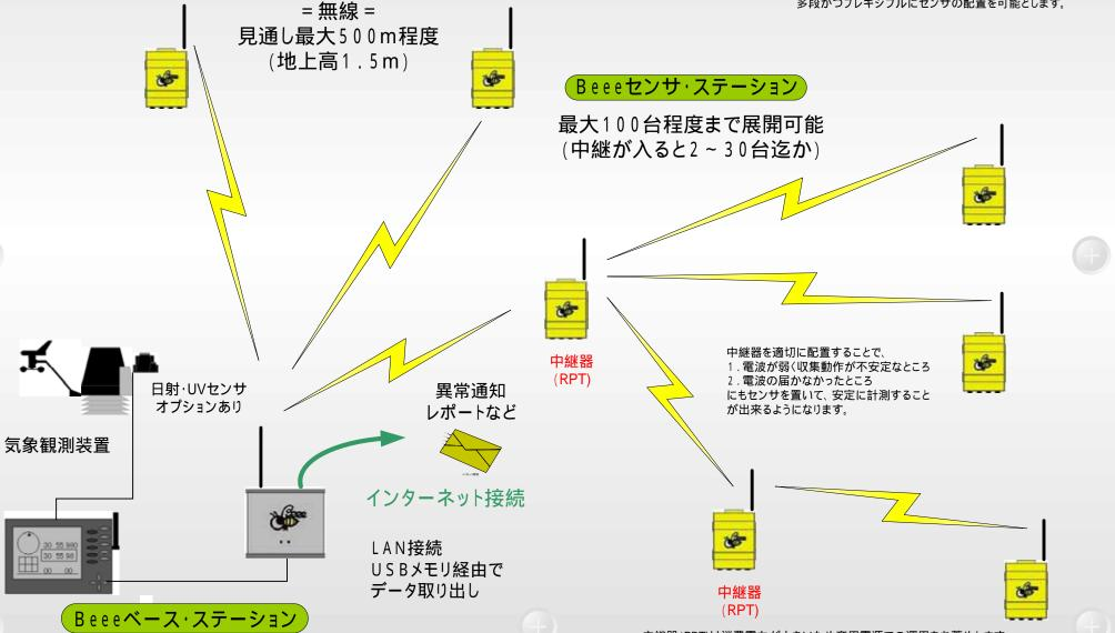
中継器(PRT)は消費電力が大きいため商用電源での運用をお薦めします。 形状は、センサ・ステーションと同じ・・・センサ接続コネクタが無いだけのものになります。
