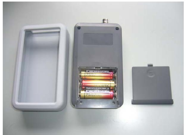
電池交換は、シリコンカバーを外し、本体裏側にある電池収納部カバーを開けて行ってください。長期間使用しないときは、電池は抜いてください。
