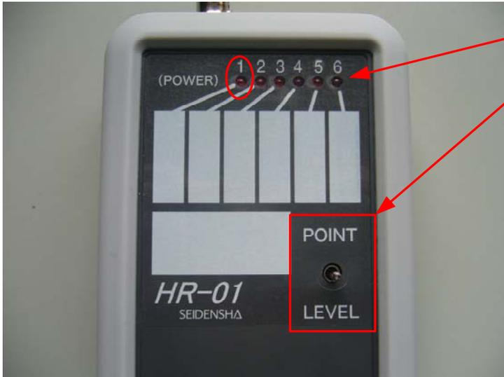
トグルSWで、ID(POINT:設置場所)情報と、信号強度情報(LEVEL)を切り替えて表示します。中立の位置で、電源OFFです。信号強度情報(LEVEL)を選択した場合、受信ブザーは鳴りません。
