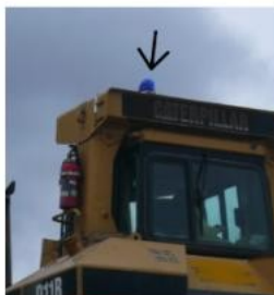
重機屋根上へのパトランプの取り付け
