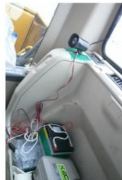
重機座席後部への本体、サイレン、バッテリー(オプション)の設置
