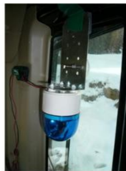
重機内へのパトランプの取り付け
