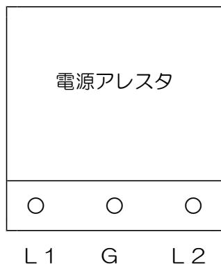
L 1 / L 2に、AC 100Vを接続／給電して下さい。
