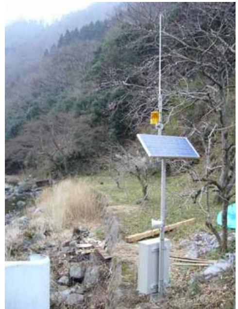
住宅のある岸の対岸に設置 日射時間が気になる谷間への設置
