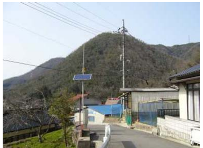
集落の中心に設置 いわゆる生活ノイズが受信されます (ノイズフローが高い) 少し受信感度を下げて設定しました
