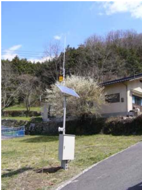
雪国仕様／パネル取付角度45° 管材は全てステンレスを採用
